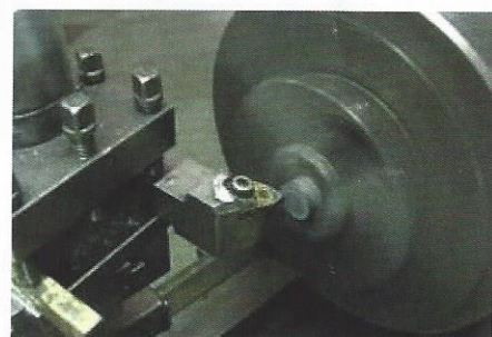
Figura 9 - Faceamento da amostra pré-sinterizada.
